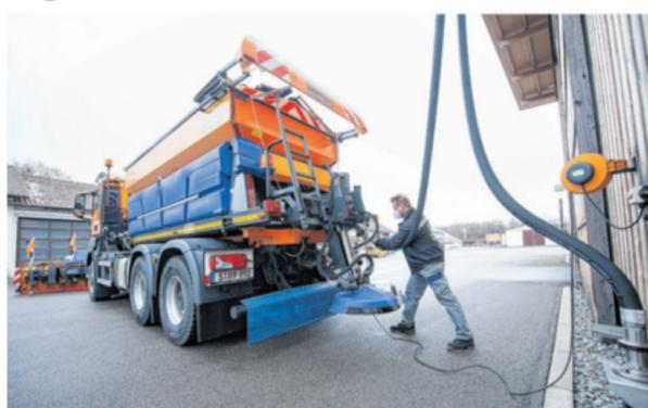
Über einen Schlauch wird die Salzlösung in Lastwagen gepumpt. *dpa*
