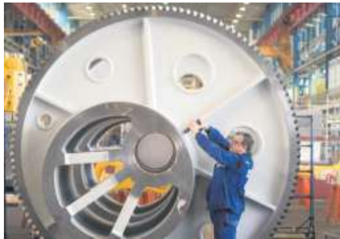
Volle Arbeitskraft: Schmierbohrung an einem Exzenterrad Foto: dpa
